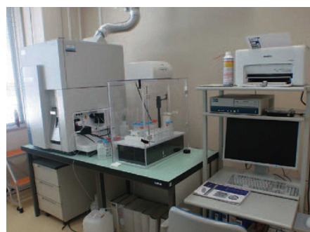
誘導結合プラズマ質量分析装置 (水中の金属元素を測定)
