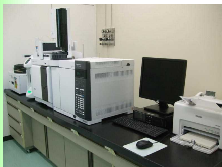
ガスクロマトグラフ質量分析装置 (水中のかび臭を測定)
