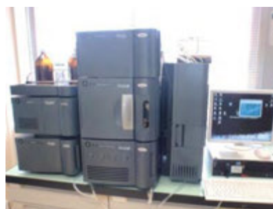
超高速液体クロマトグラフ装置 (水中の合成洗剤を測定)
