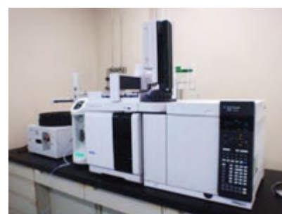
ガスクロマトグラフ質量分析装置 (水中のカビ臭を測定)
