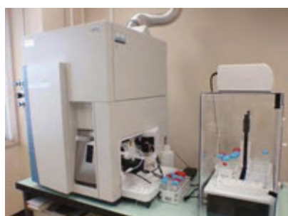
高周波誘導結合プラズマ質量分析装置 (水中の金属元素を測定)
